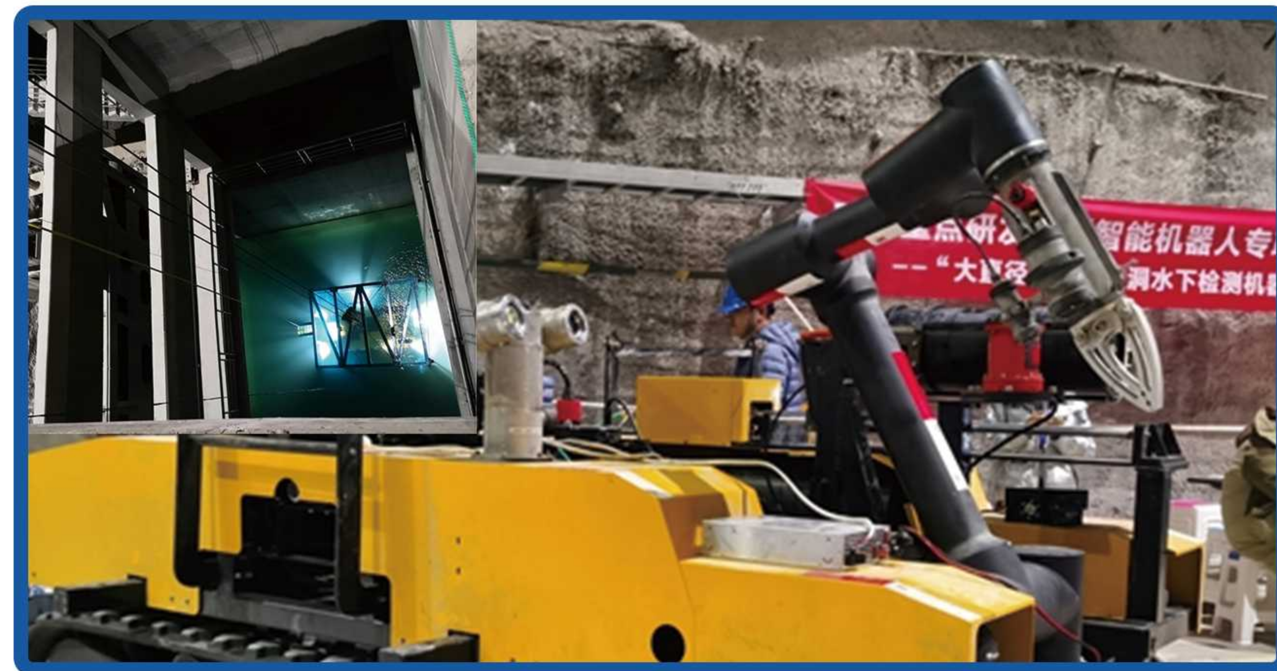
国内首台水下检测机器人多自由度作业机械臂 中国广核集团有限公司、国家重点研发计划“智能机器人”重点专项
