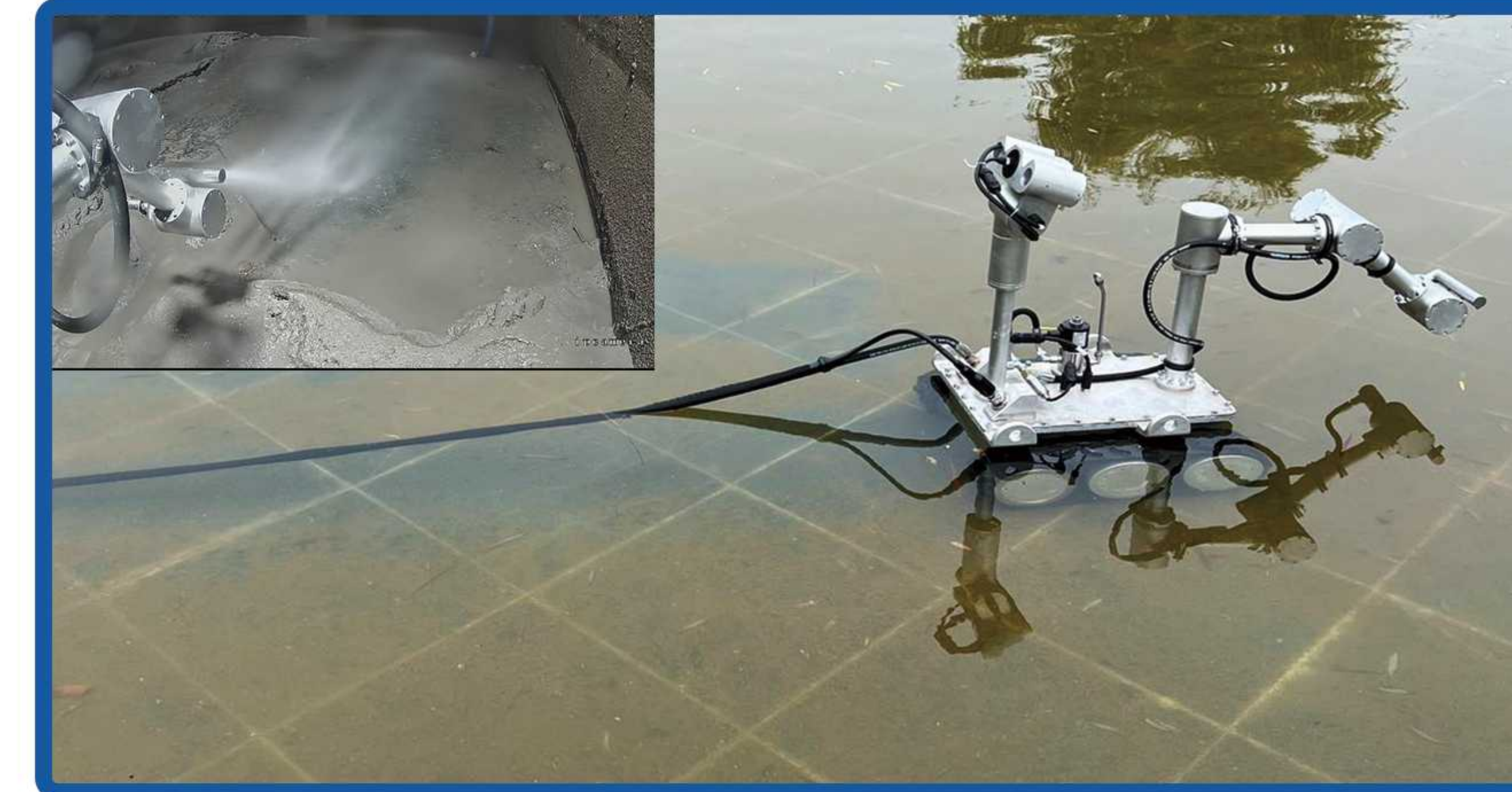
国内首台蓄水池清淤机器人多自由度机械臂 国核运行
