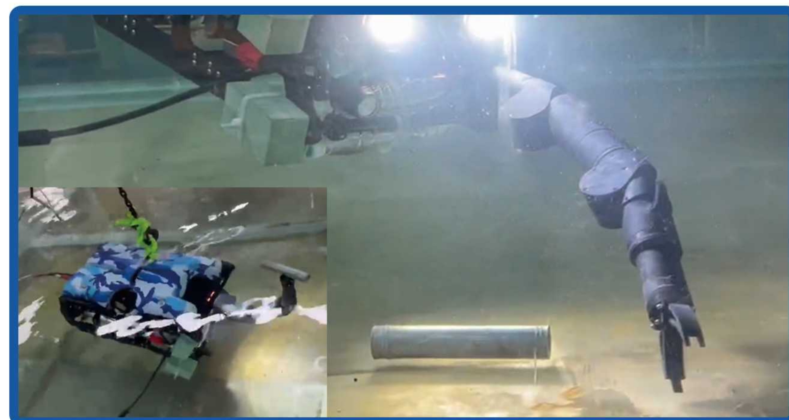
国内首台电动五自由度水下机械臂 联合研发量产
